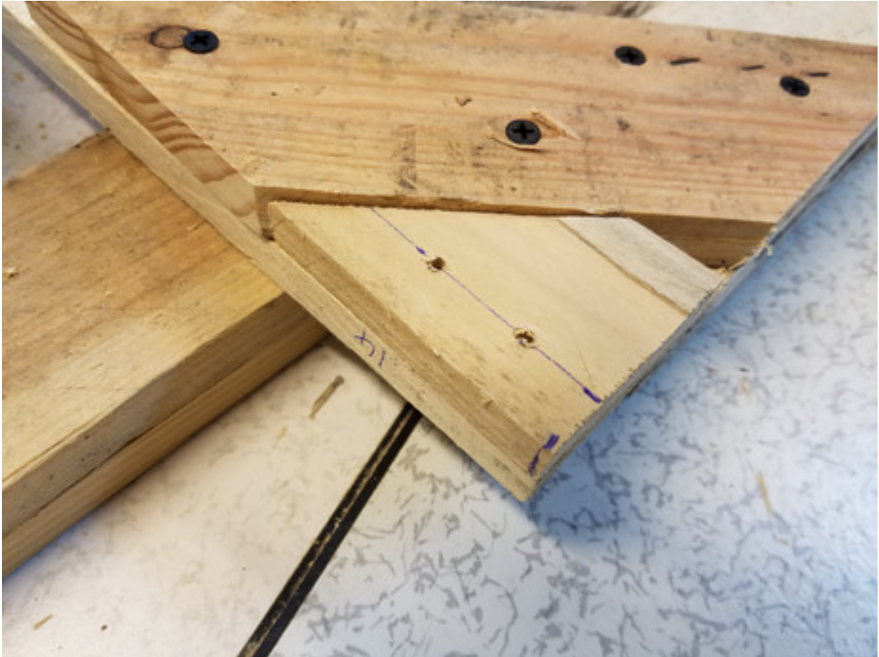
FIGURE 3.14. – gabarit de perçage en place, je m’apprête donc à percer à travers les trous existants
