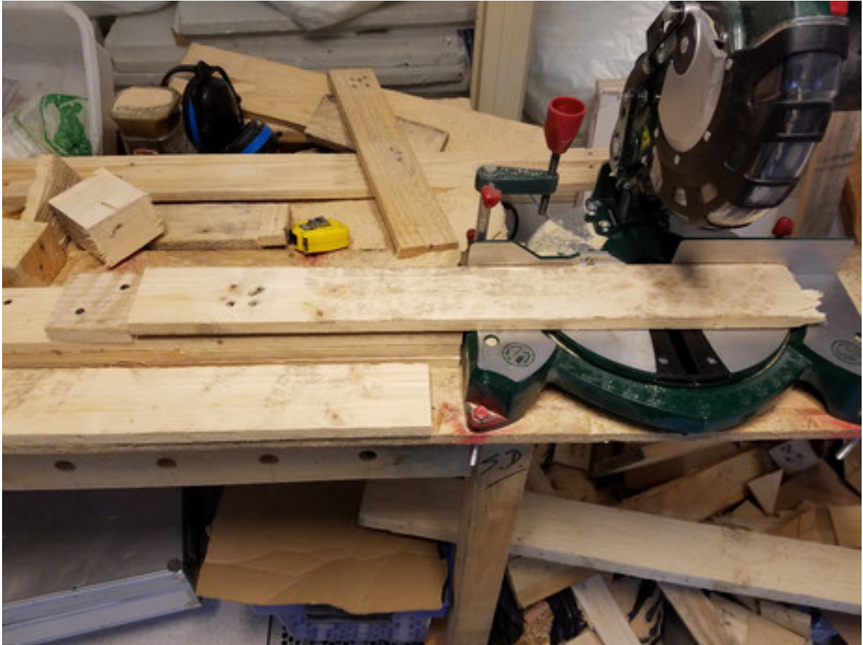
FIGURE 1.5. – planche de 50cm en place contre le gabarit avant coupage
