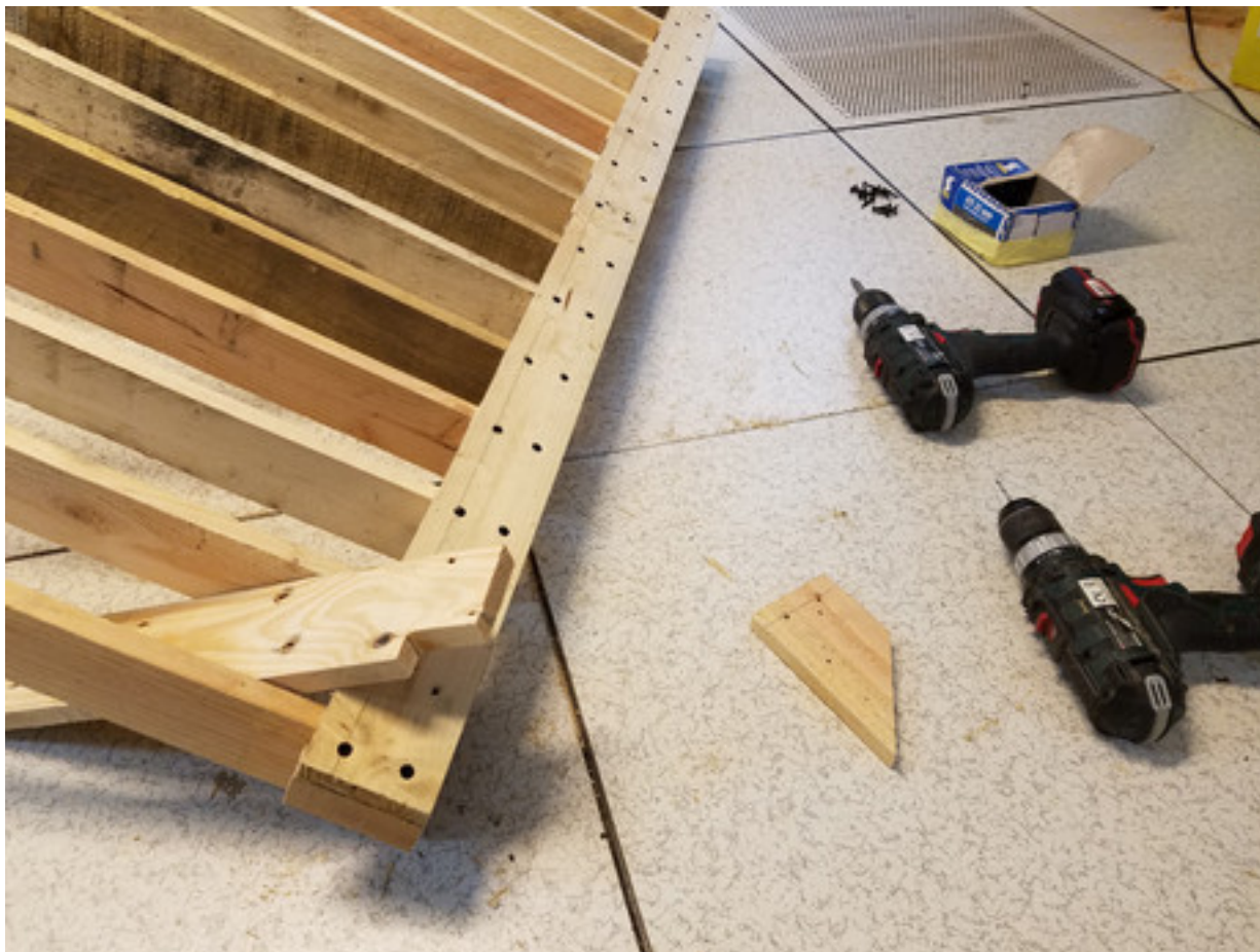
FIGURE 4.33. – toutes les équerres vissées que la 3ème planche de maintient
