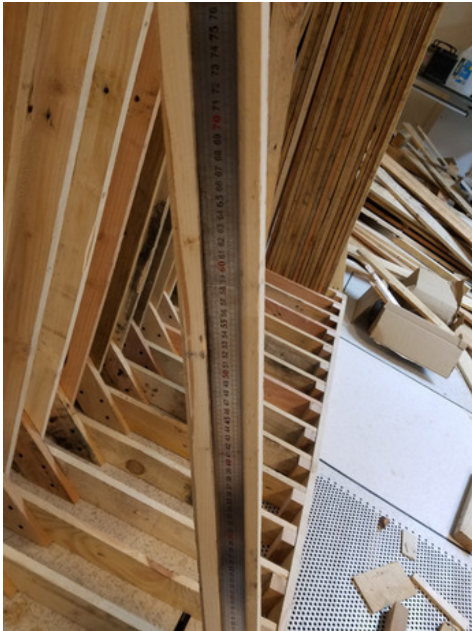
FIGURE 6.41. – règle en fer posée sur la planche de mesure pour vérifier que c'est bien droit
