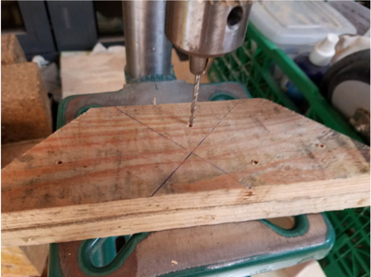
FIGURE 2.9. – perçage à travers la 1ère équerre
