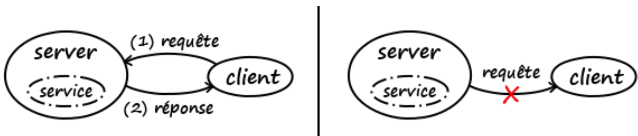
FIGURE 3. – Architecture client-serveur. Le client peut contacter le serveur et le serveur lui répond (à gauche).
